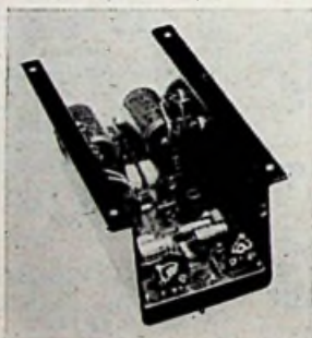
AM 50SP HI-FI versterker met groot vermogen 45 - 55 V AC DC ingang 0,2 - 1 V 100 k \Omega uitgang 30 - 55 W sinus 16-3,5 \Omega 12 - 60.000 Hz 16 halfgeleiders
